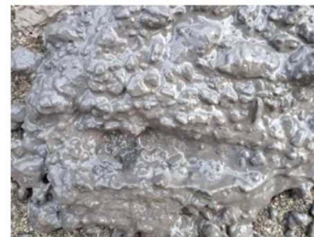
Charakteristický odvrtek z prostředí prachovitých břidlic 11,5-15 m.
