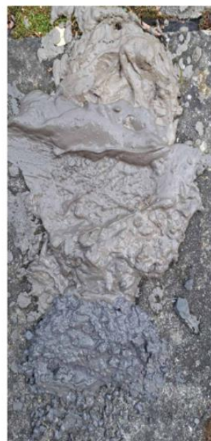
Charakteristický odvrtek z prostředí prachovitých břidlic 11,5-15 m.
