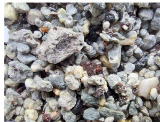
Detail drobných úlomků promyté horninové drtě z hloubky cca 40-45 m.
