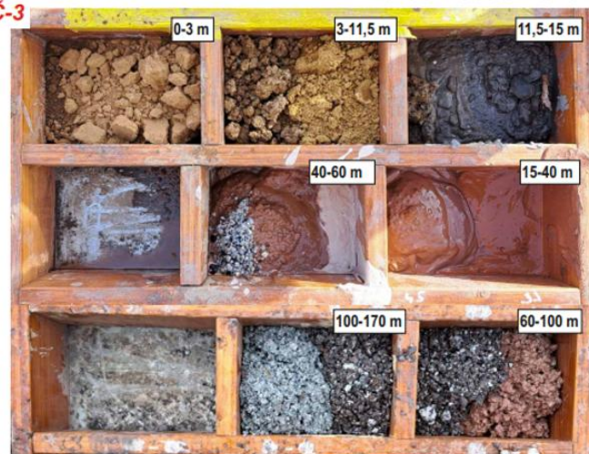
Vzorkování vrtné drtě z vrtu TČ-3.
